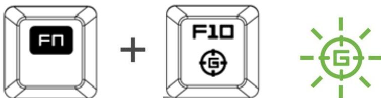
激活“游戏模式”允许你禁用 Windows 键，避免误按影响到游戏。此外，你还能通过 Razer Synapse 2.0 中的“游戏模式选项卡”，禁用 Alt + Tab 和 Alt + F4。此外，您还可以通过激活游戏模式功能来最大限度地提高按键防冲突的效果。开启此功能后，指示灯会亮起。
